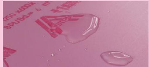
**Austrotherm XPS®** sa glatkom površinskom strukturom (tipovi 30, 50 i 70) ne upija vlagu
